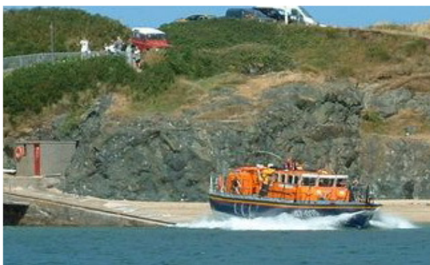
Fig. 1 Ambarcațiune pe calea ei de lansare care utilizează planul inclinat fie la ridicarea unor greutăți, fie la coborârea lor. Un exemplu este prezentat în figura 1 cu o ambarcațiune lansată la apă.
